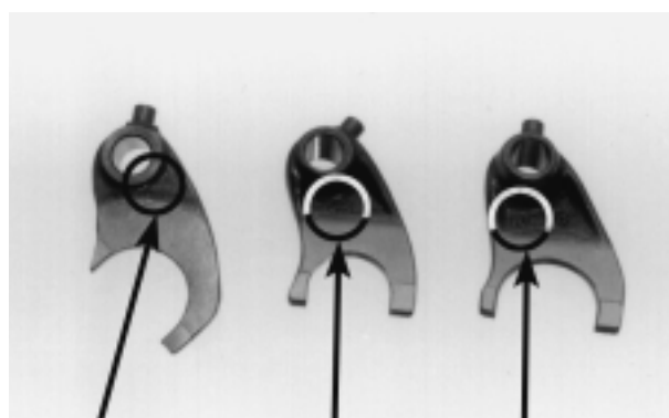
MARCA L MARCA C MARCA R TAMBOR SELETOR GARFO SELETOR ESQUERDO
