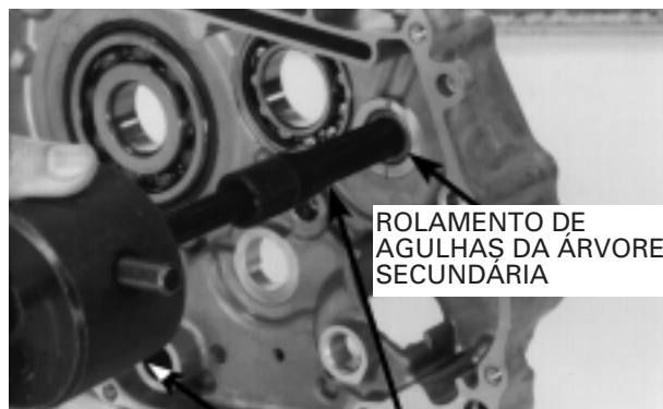
CONTRAPESO DO EXTRATOR EXTRATOR DE ROLAMENTO CONTRAPESO DO EXTRATOR
