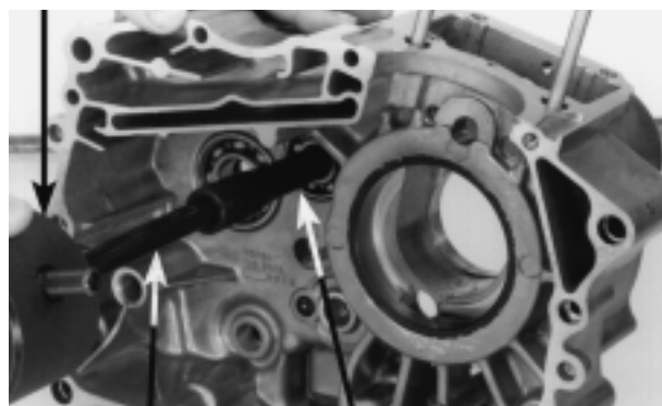
EXTRATOR DE ROLAMENTO ROLAMENTO DA ÁRVORE PRIMÁRIA INSTALADOR
