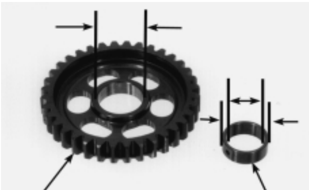
ENGRENAGEM BUCHA DA ENGRENAGEM ÁRVORE PRIMÁRIA
