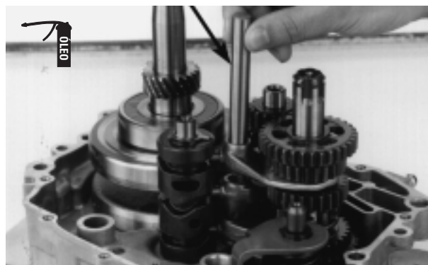
GARFO SELETOR GARFO SELETOR DIREITO CENTRAL EIXO DO GARFO SELETOR
